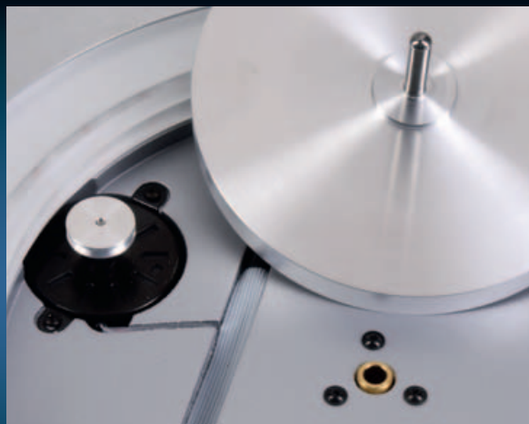
INNERE SCHÖNHEIT: Der Teller rotiert auf einem Lager aus Bronze, der Riemen wird über einen zweiten, passiven Außen-Pulley gespannt.
