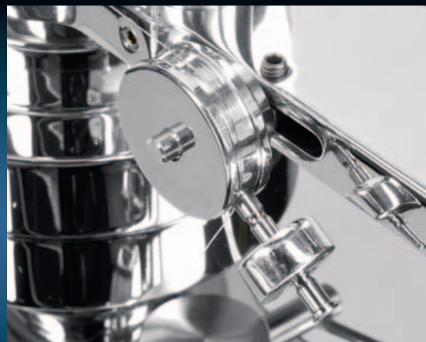
BIS INS KLEINSTE DETAIL: Der 10-Zoll-Tonarm wird kardanisch gelagert. Das Antiskating stellt man über ein Gegengewicht an der Basis ein.
